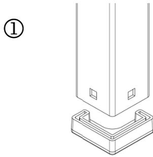
① Abschlusskappen auf Stehprofil setzen und mit weichem Hammer anklopfen.
